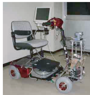
図 1: 電動四輪車の知的自動運転システム (ピーシャン・マシナリー社製「Shoprider」に機器を搭載)
